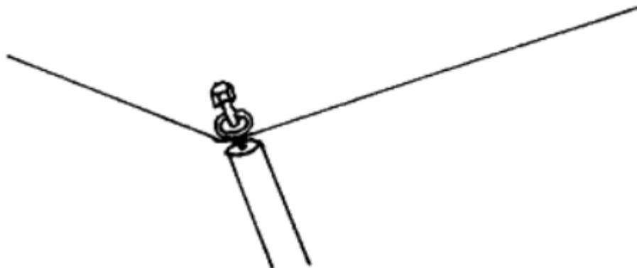
In den übrigen 10 Ösen der beiden Dächer werden die Seile (F) befestigt, so dass sie nach außen aufgewickelt hängen. Wir hatten das Seil durch die Öse und auf der Innenseite noch durch ein Stück Holz gezogen und dann verknotet.
