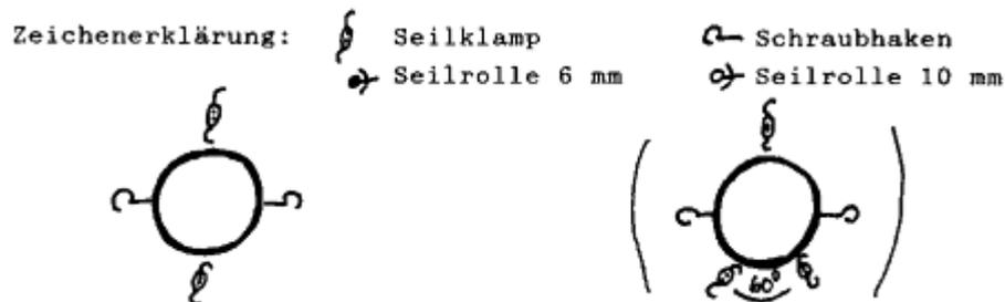
Die Seilklampen werden mit Holzschrauben befestigt. Dann wird der Mützenreiter von oben auf den Stamm geschoben. Nun werden die oberen Dinge wie folgt angebracht:
