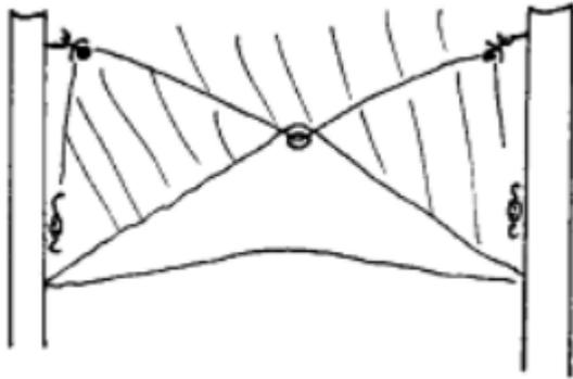
Durch diese Seilrollen werden die Seile (H) geführt und am Stamm entlang an einem Seilklamp, der ca. 20 cm über dem Wasserauffänger sitzt, befestigt. Durch gleichmäßiges Abspannen zweier Seile an einer Öse, wird das äußere Dach an dieser Stelle nach oben gezogen, so dass sich eine Rinne bildet, in der das Wasser zu den Stämmen in die Wasserauffänger fließen kann.
