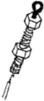
Mit einer Spezialschraube werden nun die Ösen der Dächer an den Stämmen der hohen Jurte mit den Jurtenseitenplanen verbunden und dann mit der Schraube in den Schraubhaken eingehängt. Die niedrigen Jurten werden jetzt mit den Teleskopstangen nach außen abgespannt, wobei an den Nahtstellen der Dächer wieder die Spezialschrauben verwendet werden, da die vielen Ösen sonst vom Pin der Stange abrutschen würden.
