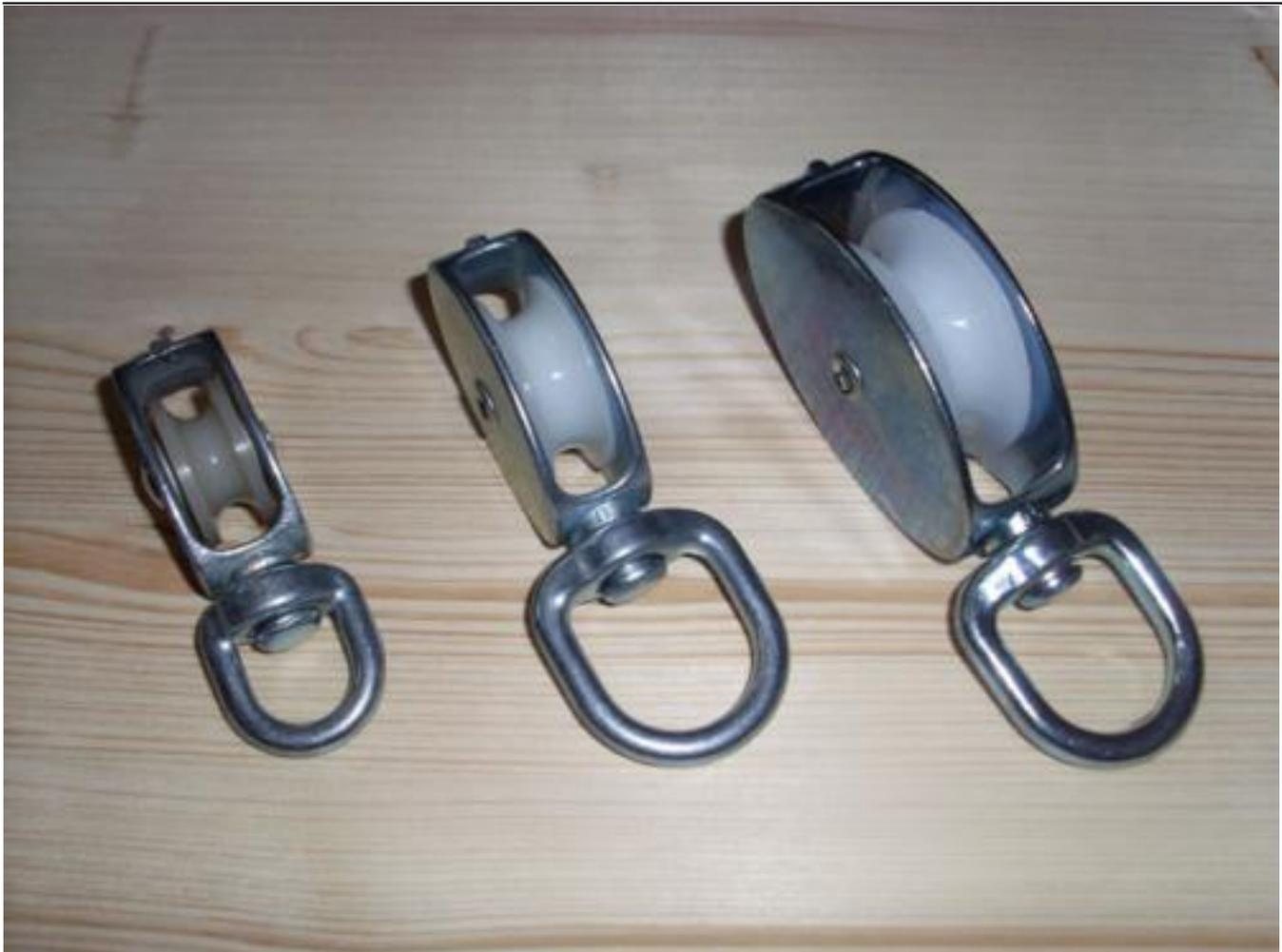
Die Blockseilrollen gibt es sowohl mit festem Auge als auch mit Wirbelauge. Sitzt die Rolle an einem festen Umlenkpunkt, wie z.B. in der Spitze des Dreibeins, dann reicht ein festes Auge. Ziehst du einen Balken über eine Umlenkrolle nach oben, dann hilft dir das Wirbelauge Verdrillungen im Seil zu vermeiden.
